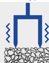
バラスト（砂利）を つき固める
